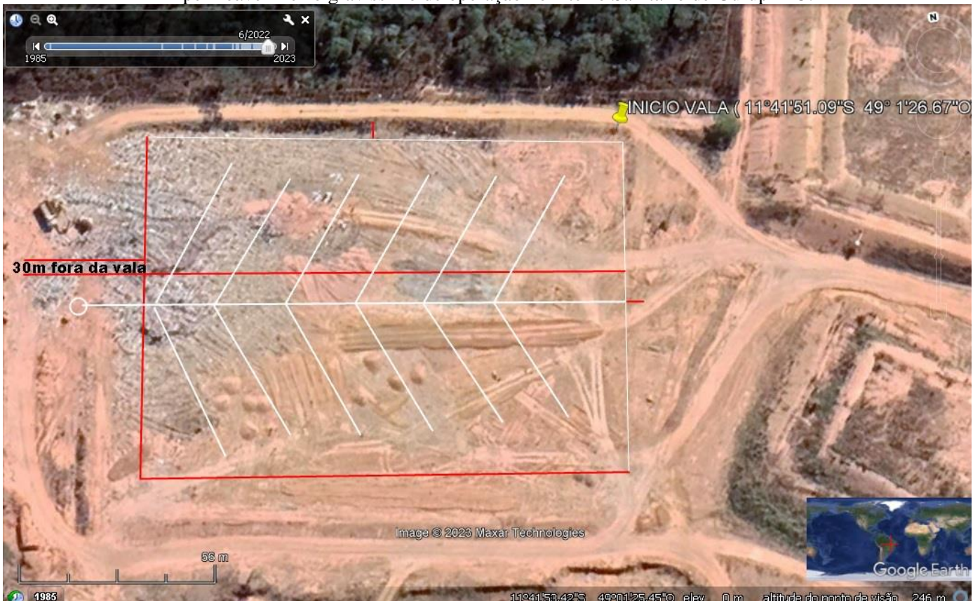
Figura 5: Imagem Temporal Vala de RSU (junho de 2022) – Nota-se resíduos depositados a 30 metros fora da vala impermeável – erro gravíssimo de operação no Aterro Sanitário de Gurupi-TO.
