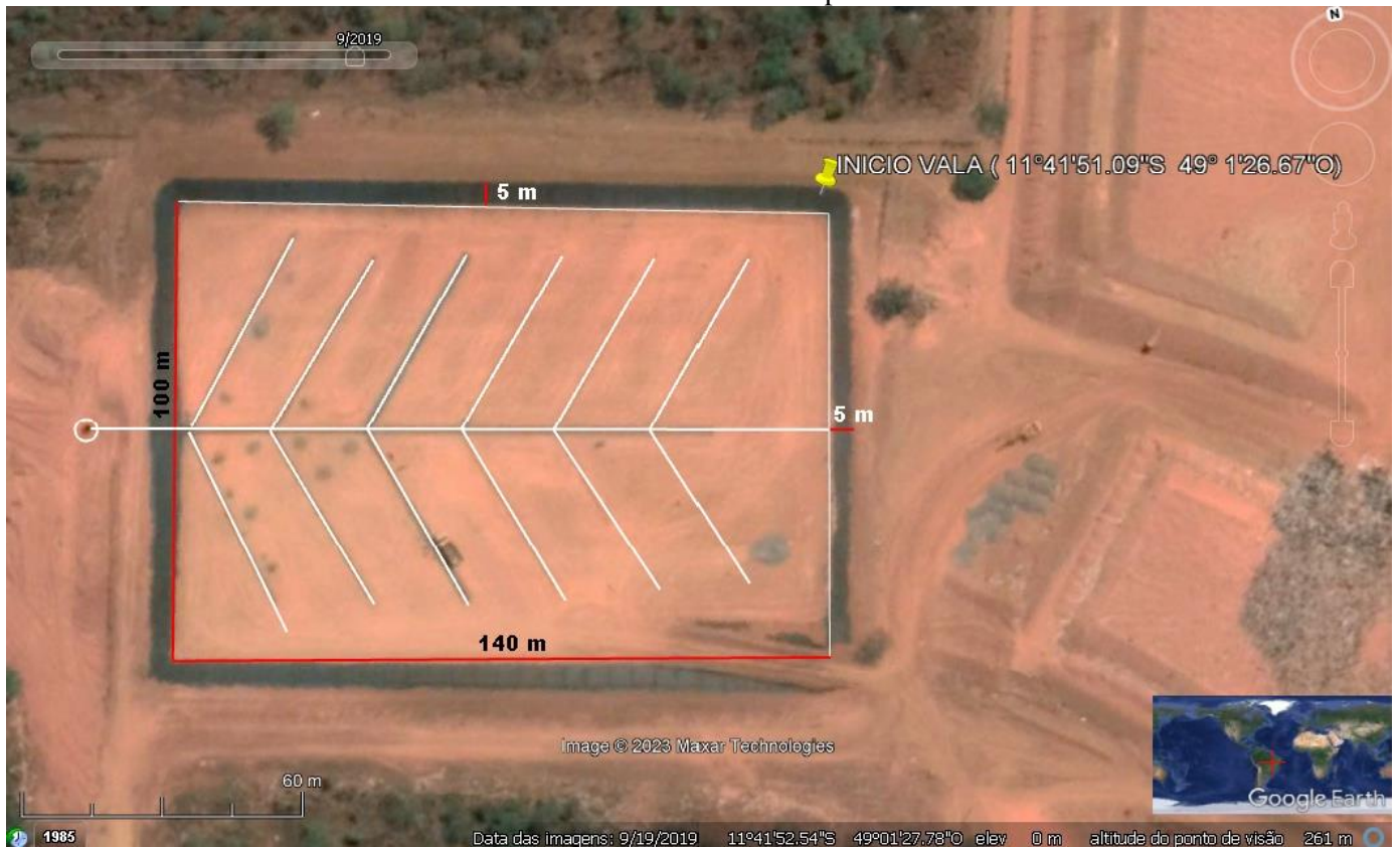
Figura 5: Imagem Temporal Vala de RSU (junho de 2022) – Nota-se resíduos depositados a 30 metros fora da vala impermeável – erro gravíssimo de operação no Aterro Sanitário de Gurupi-TO.
